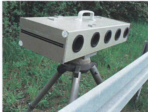
Abbildung 4-1: Sensorkopf einer ES3.0
