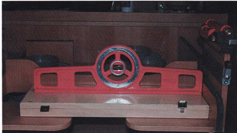
Anlagenbild 1: Messgerätebesichtigung - Neigungswasserwaage
